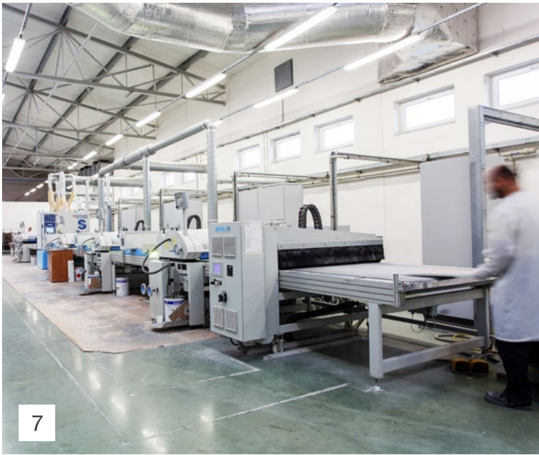
5 | ДВУПЛЕЧЕВОЙ РОБОТ Робот с горячевоздушной ярусной сушилкой. 6 | НАПЫЛИТЕЛЬНЫЙ АВТОМАТ Одноплечевой автомат. 7 | ЛИНИЯ С УФ -ОТВЕРЖДЕНИЕМ Акрилуретановые лаки.
