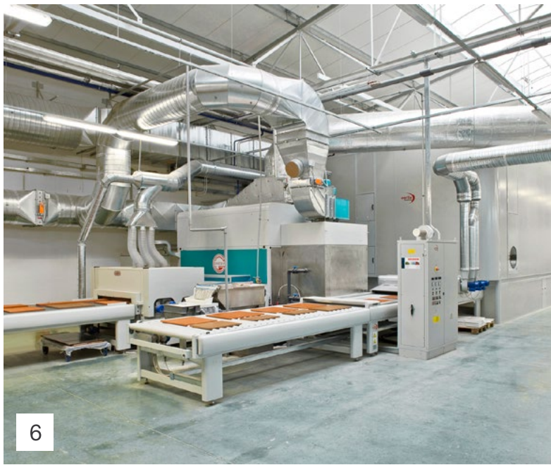
5 | DVOURAMENNÝ ROBOT Robot s teplovzdušnou etážovou sušárnou. 6 | STŘÍKACÍ AUTOMAT Jednoramenný automat s teplovzdušnou etážovou sušárnou. 7 | LINKA S UV VYTVRZOVÁNÍM Akryluretanové laky.
